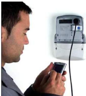
Fig. 28: Meter readout via an IR optical interface
